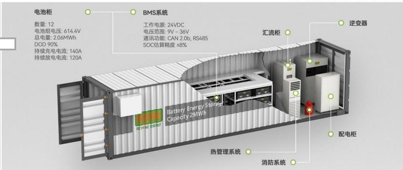
集装箱式储能系统内部结构图
