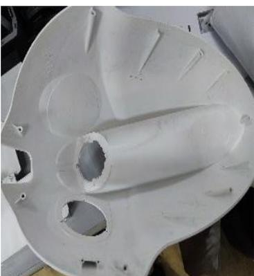
螺丝柱是制件装配紧固的必要部件，螺丝柱开裂导致装配失效是很严重的问题，材料端合适的解决方案尤其重要。
