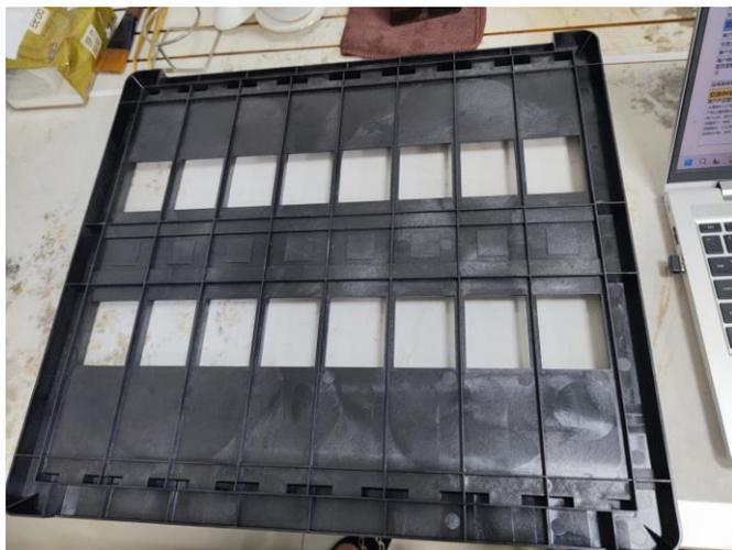
零件：固态电池转运托盘
